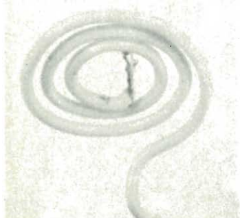
Particolare del sensore in filo isolato di cui si è fatto uso per le prove.
